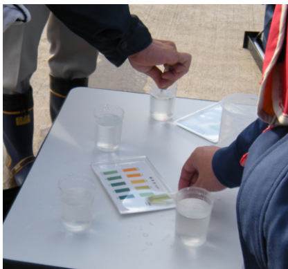
パックテストという道具で、水中の有機物の量や、酸性・アルカリ性の度合いなどを測ります。
