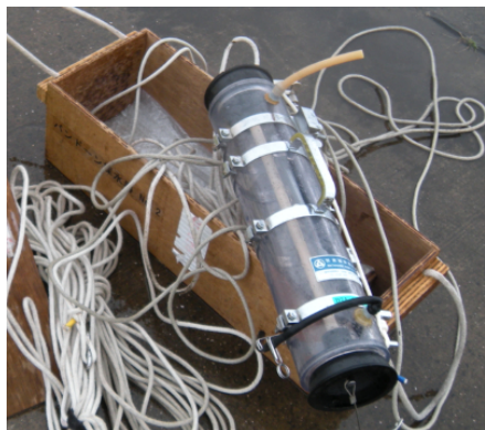
現場で水を採取するための道具です。現場の状況によってはバケツにヒモをつけて使ったりもします。
