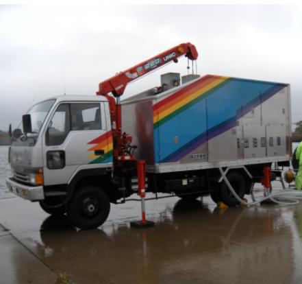
こちらは油回収車です。 水から油だけを取り出して回収することができます。
