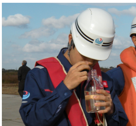
現場で水を採取するための道具です。現場の状況によってはバケツにヒモをつけて使ったりもします。
