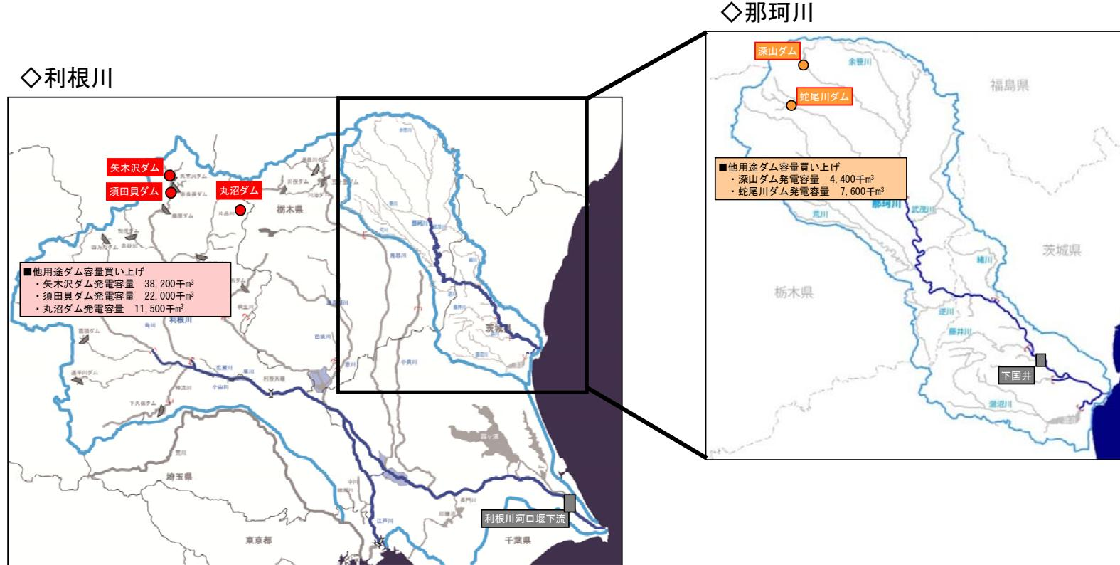
図 4.4-51 流水の正常な機能の維持対策案の概要 ケース3 他用途ダム容量（発電容量）買い上げによる流水の正常な機能の維持対策案
