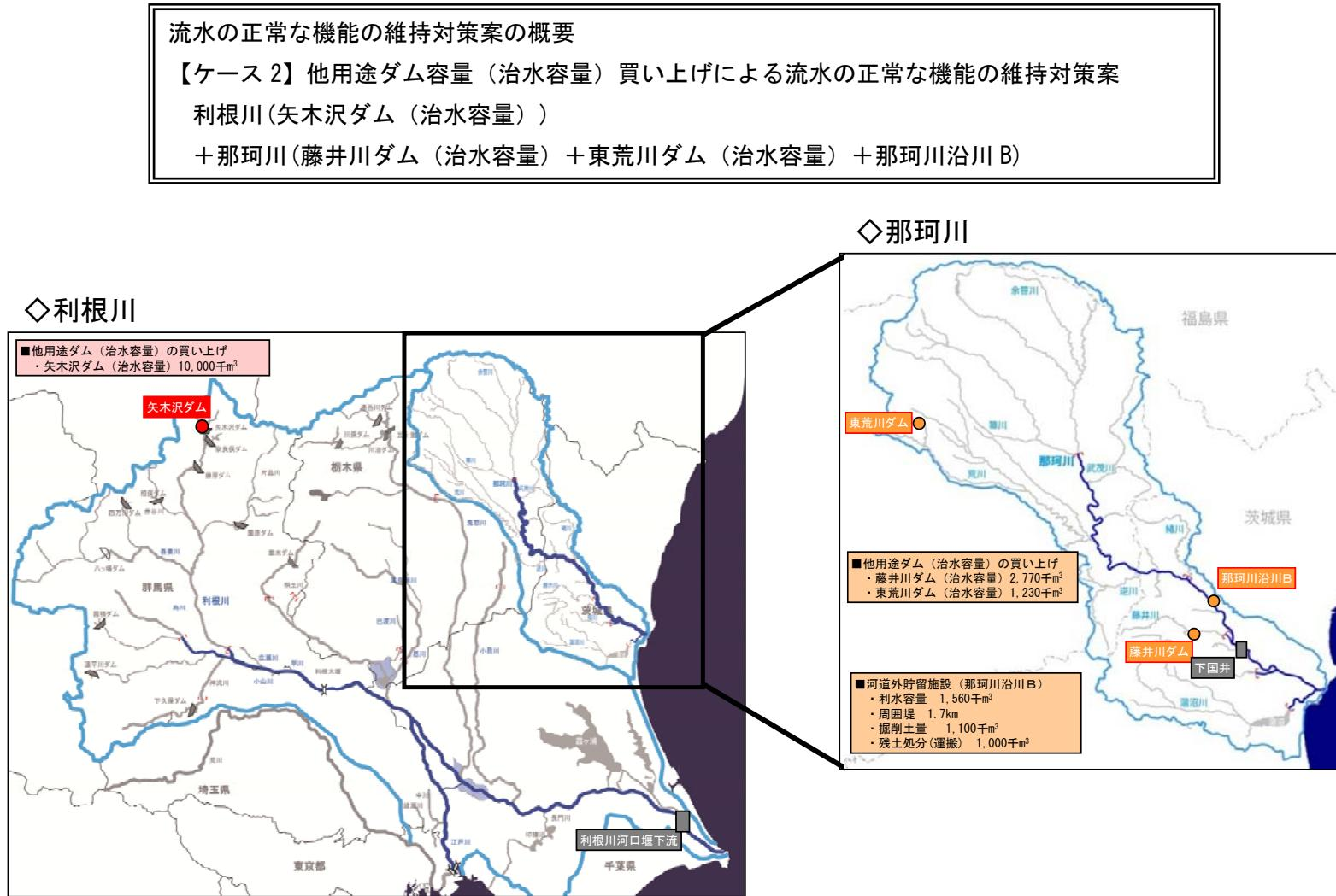
図 4.4-50 流水の正常な機能の維持対策案の概要 ケース 2 他用途ダム容量（治水容量）買い上げによる流水の正常な機能の維持対策案
