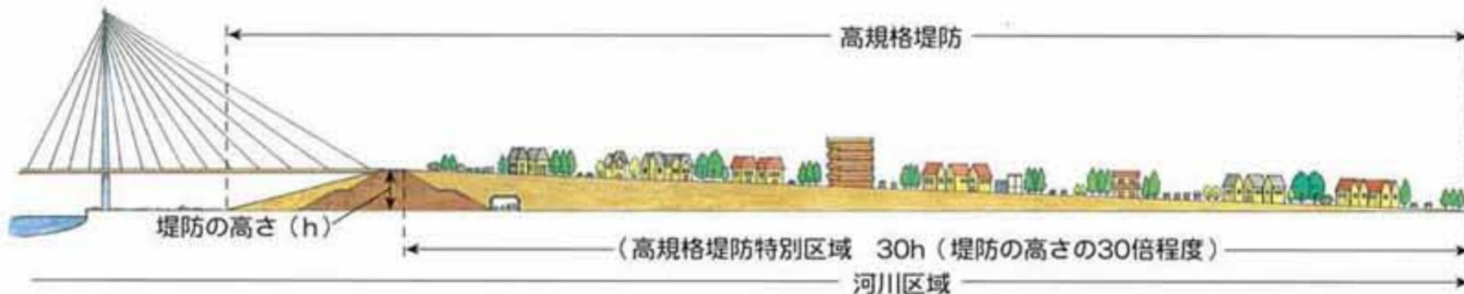
高規格堤防は、東京・大阪の5水系6河川で整備が進められており、荒川は、河口から熊谷大橋までの両岸約80kmが高規格堤防を整備する区間となっている。
