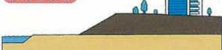
必要に応じ軟弱地盤を改良し強い地盤をつくるとともに、堤防の勾配をゆるくするため地震時の液状化<sup>⑧</sup>やすべりに強い堤防になり、高規格堤防上は地震に強いまちになる。
