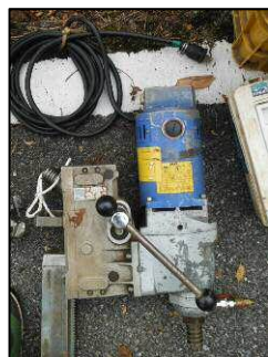
写真-6 軽量ボーリングの道具（左からマシン、支柱、発電機、ポンプ）
