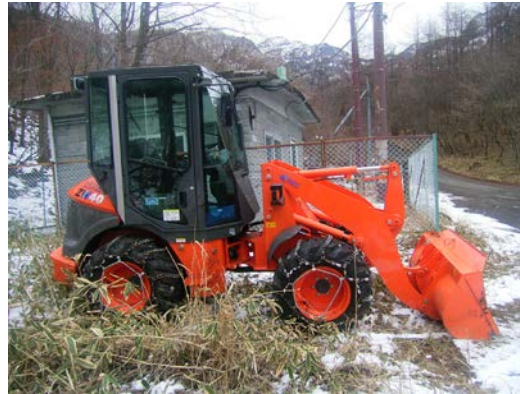
T S 0. 5 m 3 日向からの除雪
