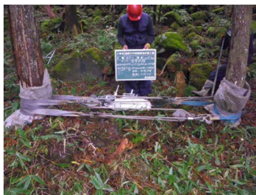
写真 3 引張り試験 \phi 300
