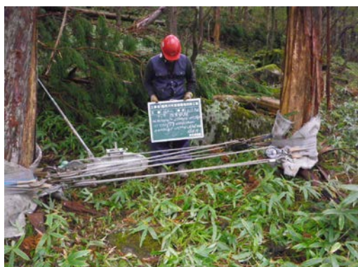
写真 2 引張り試験 \phi 400
