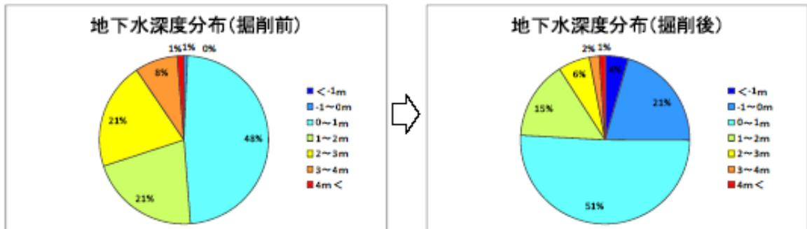
図3-7 地下水位分布の面積比変化
