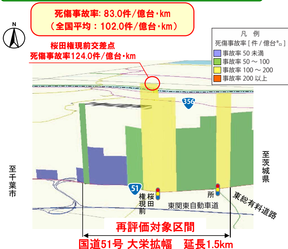
国道51号の死傷事故発生状況
