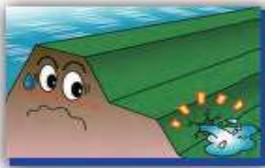
漏水とは、洪水の水が堤防や堤防の下の地面を通して住宅や農地のある側に漏れ出てくることです。
