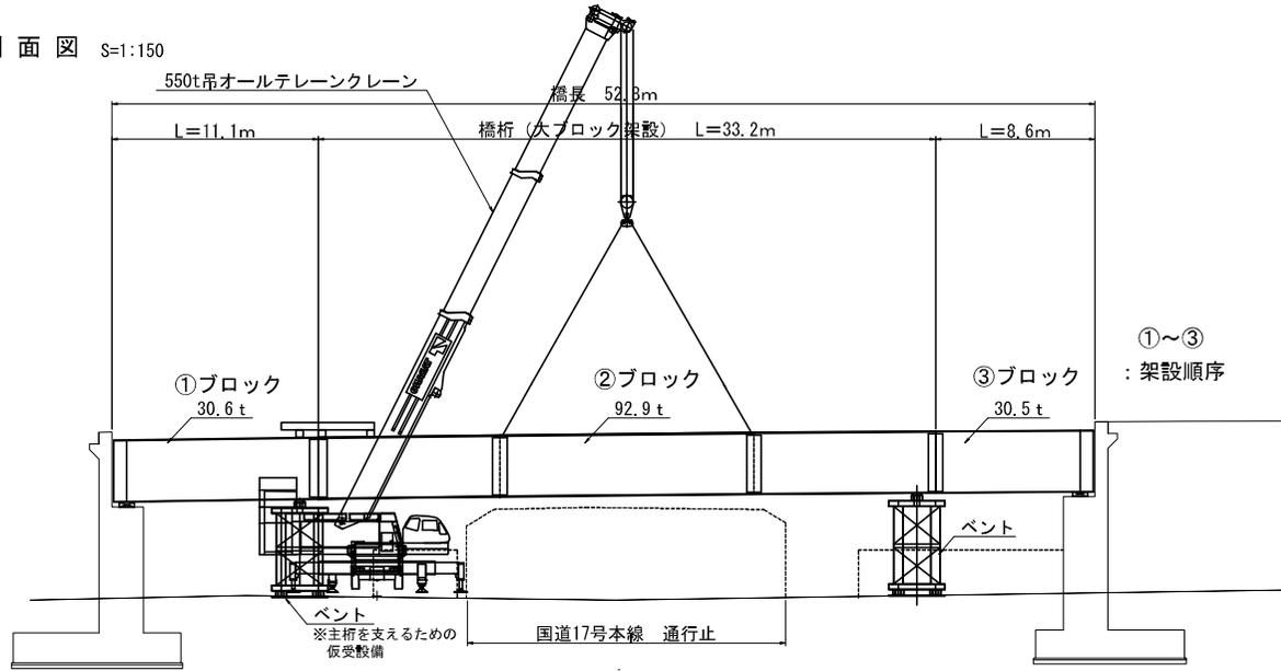
作業内容 : 大型クレーンを使用し、橋桁を架設します
