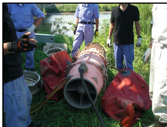
排水ポンプ (30m 3 /分/ポンプ1台)
