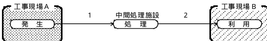
図 2 . 1 . 7 建設汚泥の『再生利用制度』のパターン
