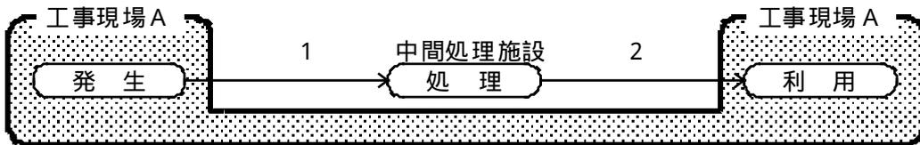
図 2.1.5 建設汚泥の『有償譲渡』のパターン
