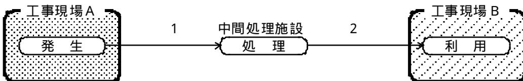
図 2.1.6 建設汚泥の『有償譲渡』のパターン
