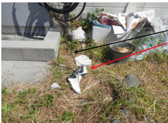
支線(電話線に負担が掛からないよう事故後に端部を屋根の上に移動)
