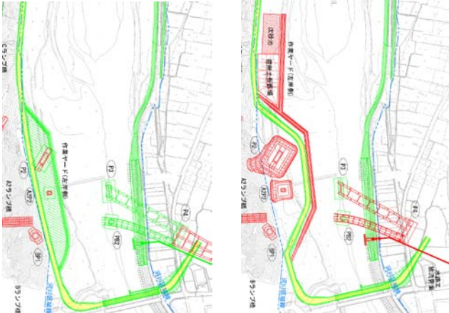
第一濁水期 (掘削+マチング+柱基部)
