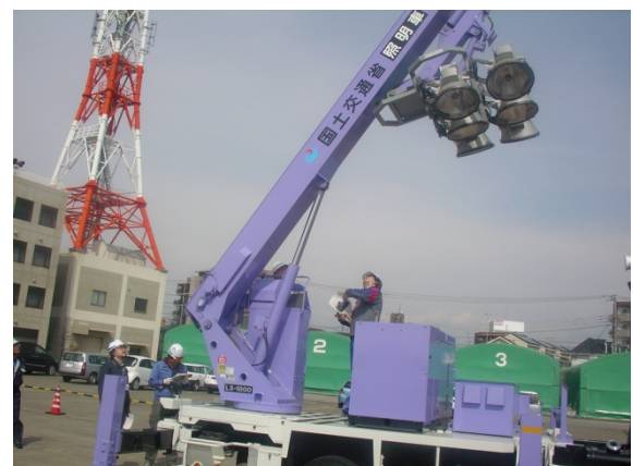
照明車の操作実習
