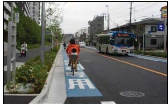
交通規制により指定された、自転車が専用で通行する車両通行帯。自転車と自動車を視覚的に分離
