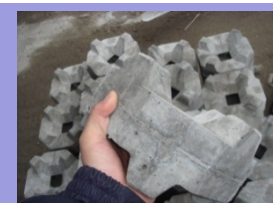
小型ブロック 魚道水路内の小型ブロック
