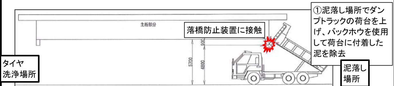
落橋防止装置損傷状況
