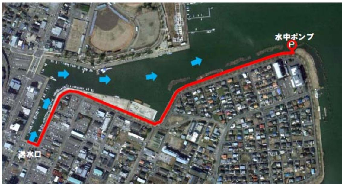
送水ポンプ概要 送水配管延長: 約930m
