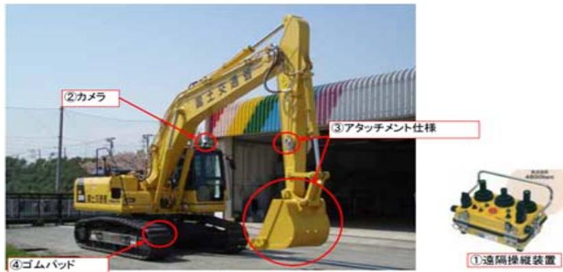
写真－４ 遠隔操縦バックホウ
