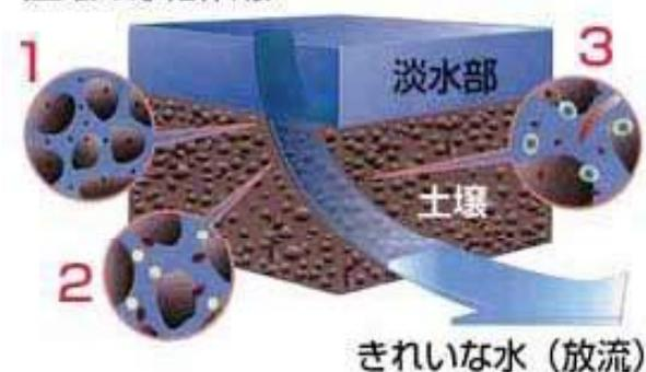
土壌によるろ過(物理的作用)、土壌中の粘土鉱物や腐植等による吸着(化学的作用)、土壌に生息する生物の活動による生物分解(生物的作用)によって汚濁物を除去する
