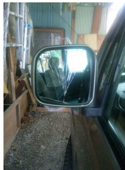
通行車両ミラー破損状況
