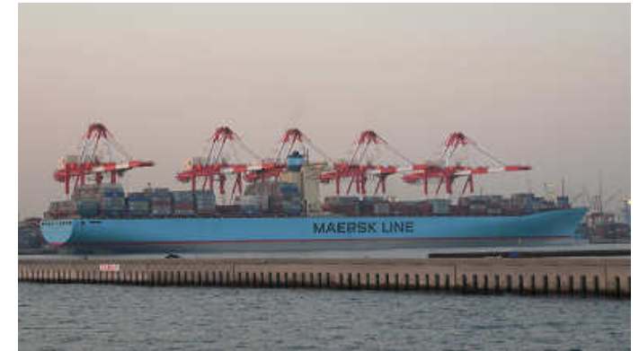
Eleonora Maersk (エレオノーラ・マースク) 諸元 船長: 397.71m 船幅: 56.4m 喫水: 15.5m コンテナ積載個数: 12,508TEU 総トン数: 170,974GT
