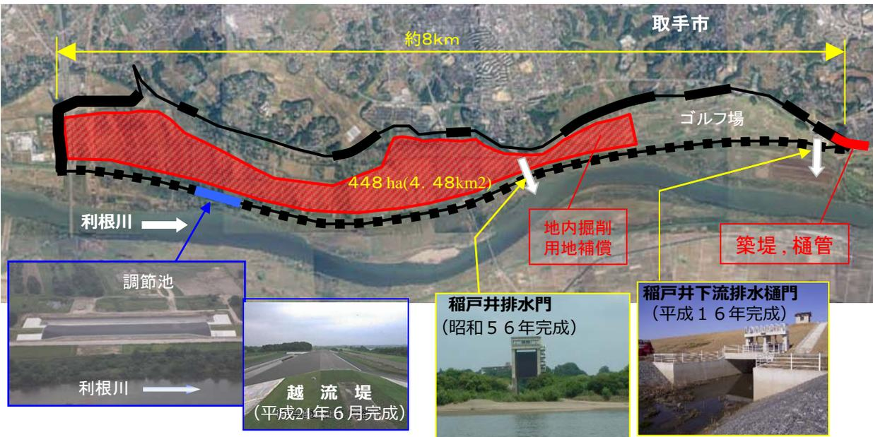
河道水位が越流堤高さを超えると、河道内の水が調節池へ入り、下流への流量を低減する。
