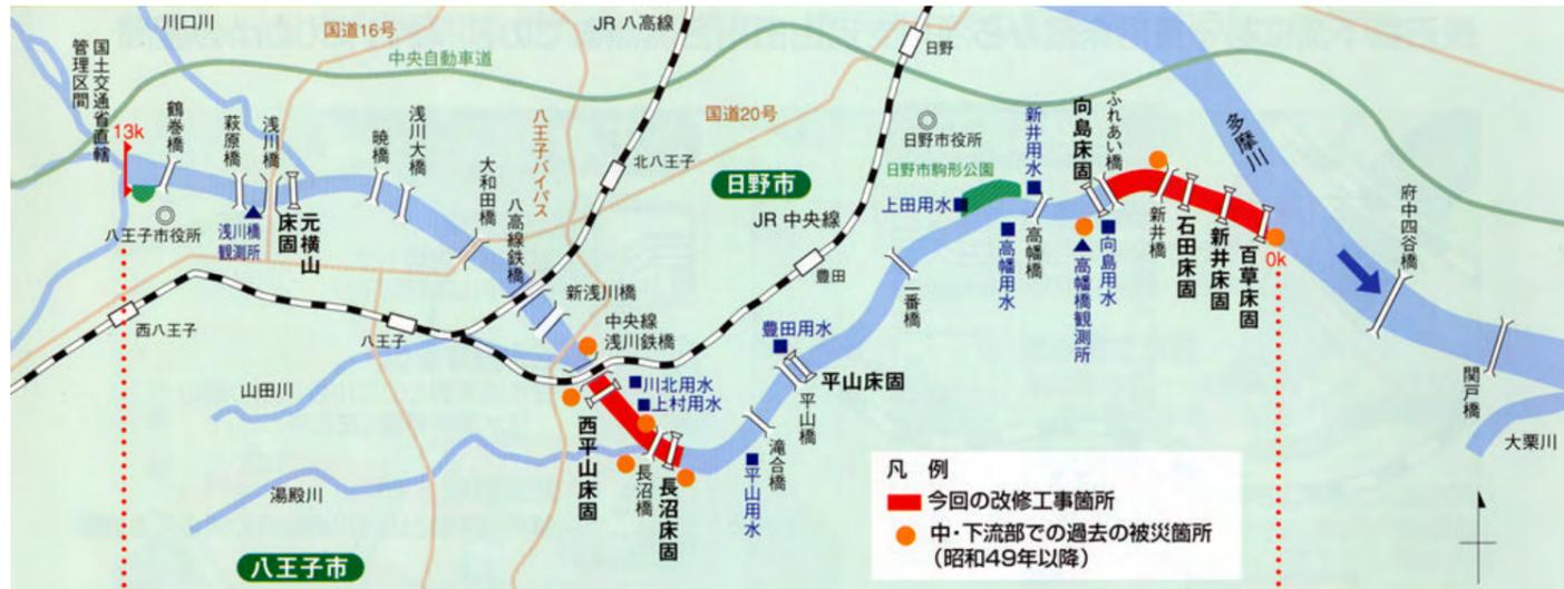
浅川では、平成 11 年 8 月 14 日の熱帯低気圧による豪雨で、百草・長沼床固が被災を受け、また、土砂の堆積や床固めなどの構造物により流下能力が不足している、下流部と中流部においては計画高水位 (H.W.L.) を超える大出水となりました。
