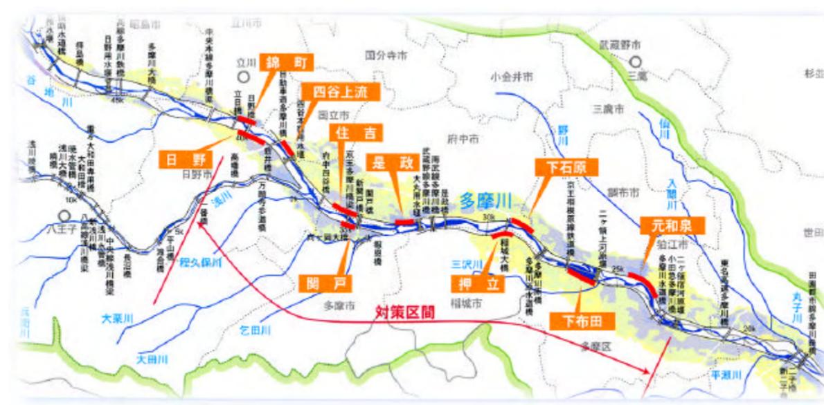
具体的な整備方法としては、『堤防を強化するための高水護岸と高水敷の造成』と『河岸を強化するための低水護岸と根固ブロック』。また、みお筋の固定化や砂州の陸域化を解消するため、土砂移動の観点から必要に応じ『対岸側の掘削と河床整正』を実施します。
