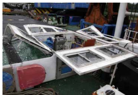
船舶損傷状況(操舵室のキャビンが破損)
