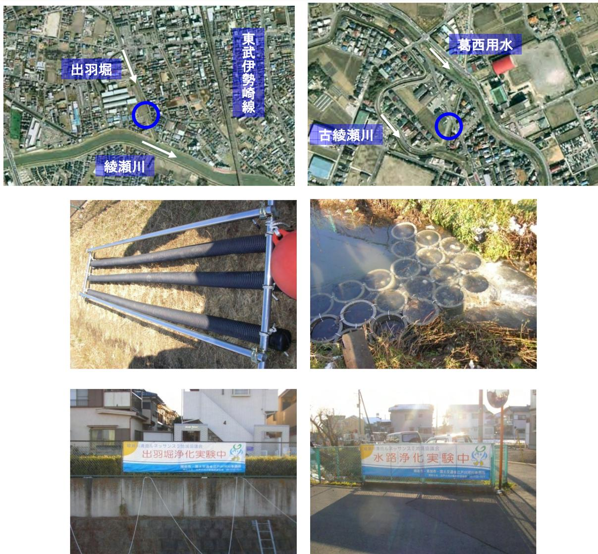
図 3.2.10 簡易浄化施設（左：出羽堀、右：古綾瀬川流入水路）
