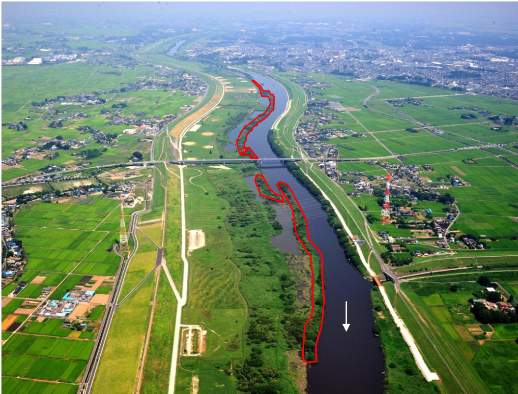
図 4-2-21 河道内の樹木の伐採のイメージ
