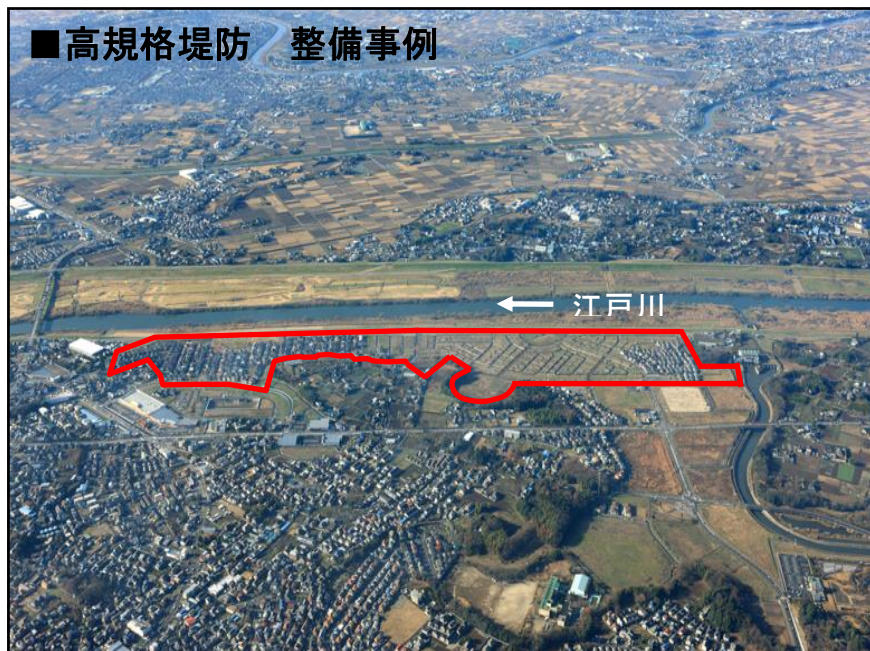
図 4-2-22 高規格堤防のイメージ
