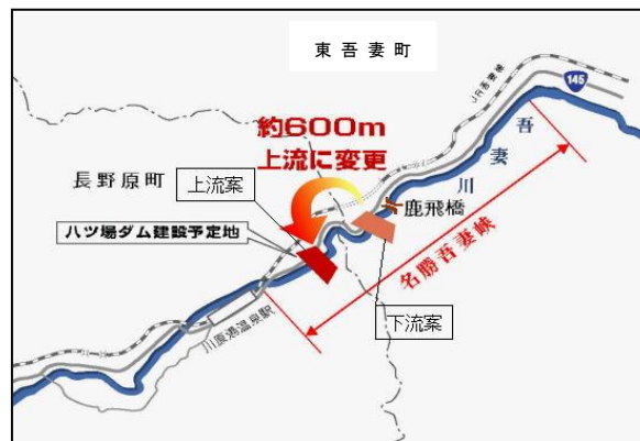
図 3-2-1 ダムサイト位置の変更状況
