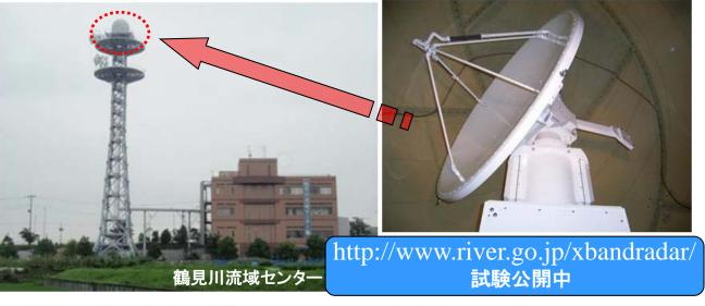
〇新横浜サイトのXバンドレーダは、(最小観測面積:1kmメッシュ、観測間隔:5分 『新横浜出張所(鶴見川流域セン ター)』横の鉄塔の最上部に設置。
