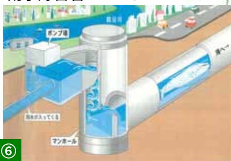
雨水貯留管イメージ
