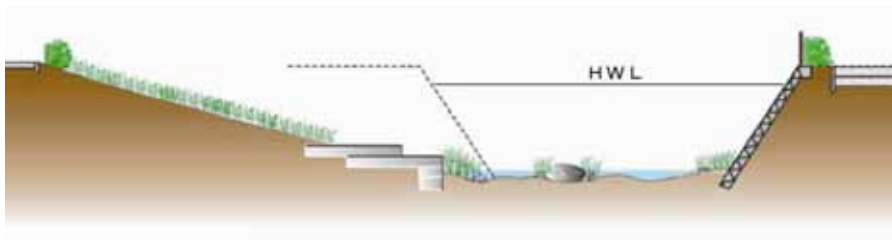
緩傾斜護岸整備区間
