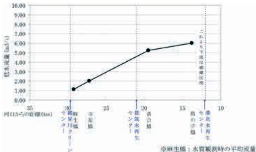
図 2.4 鶴見川本川流量縦断面図 (平成15年)
