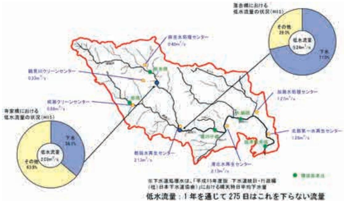
図 2.3 下水処理水の流入状況 (平成15年)
