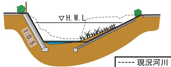
図 4.13 緩傾斜護岸の整備断面（例）
