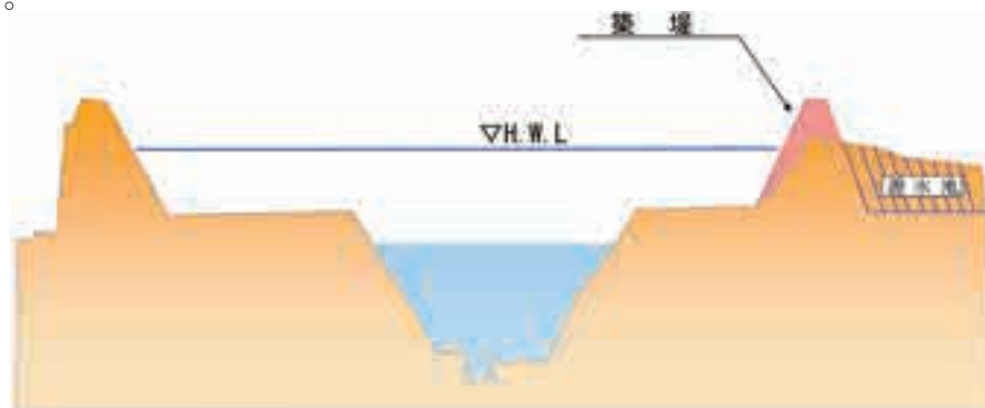
図 4.5 築堤のイメージ
