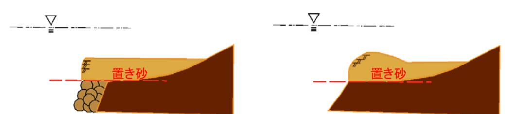
図 3-35 側方侵食地点への置き砂設置イメージ
