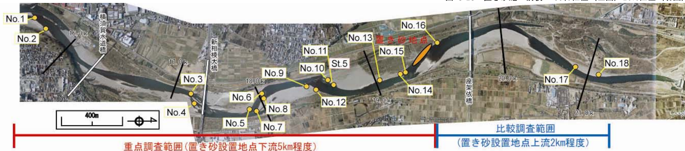
図 3-17 線格子法による河床材料調査位置図
