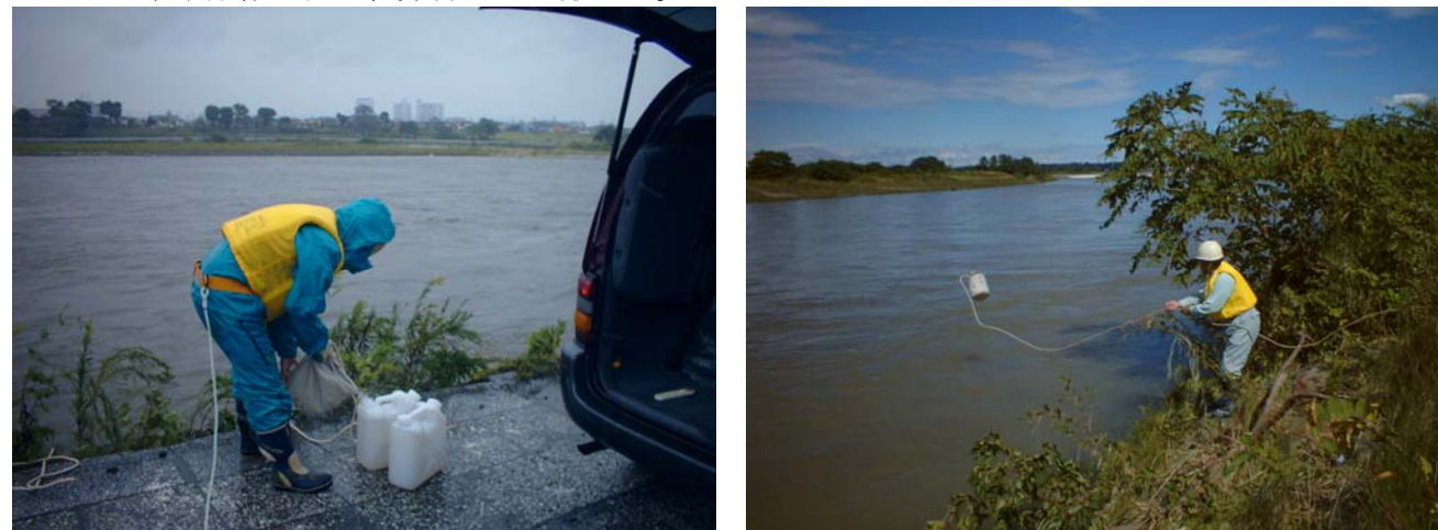
写真 3-7 採水状況(左:17.0k地点、Q=700m 3 /s時、右:20.8k地点、Q=200m 3 /s時)
