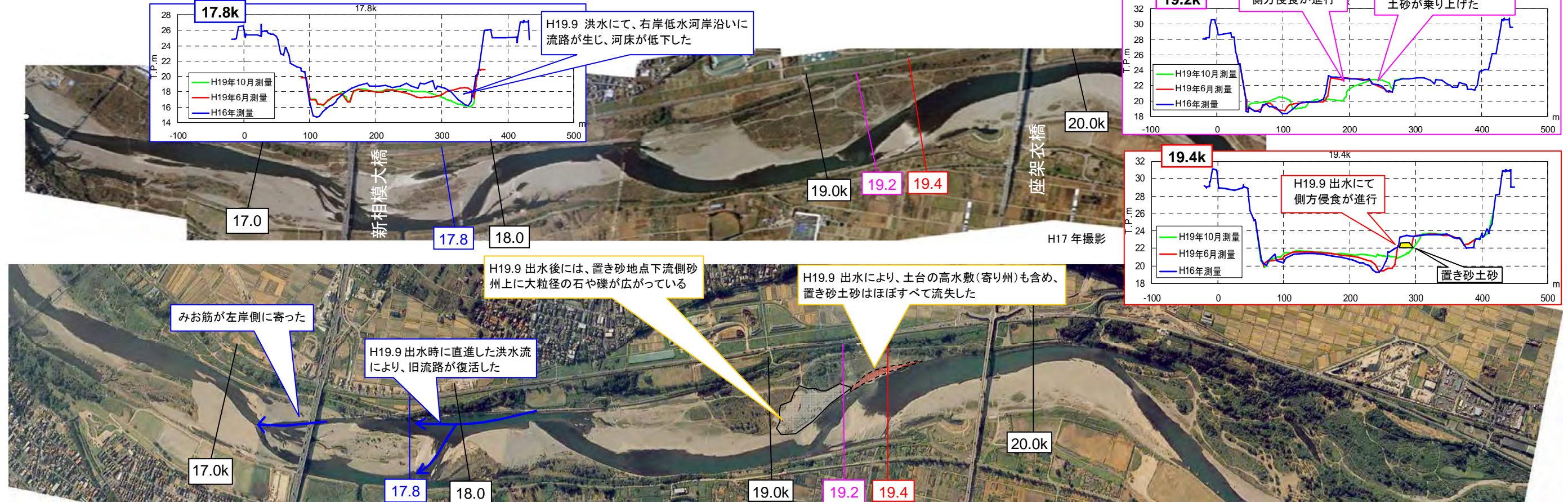
図 3-14：置き砂下流の河道の変化
