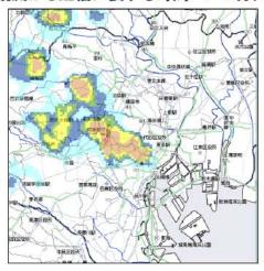
※Cパンドレーダ(定量観測半径120km)は広域的な降雨観測に適するのに対し、XパンドMPレーダ(定量観測半径60km)は 観測可能エリアは小さいものの局地的な大雨についても詳細かつリアルタイムでの観測が可能。
