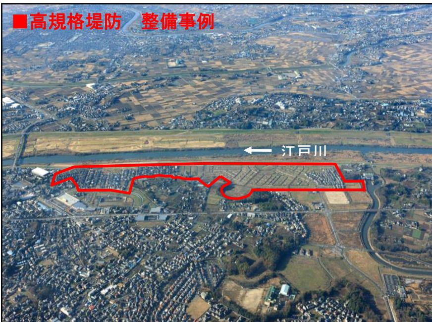
図 4-2-22 高規格堤防のイメージ
