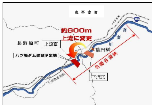
図 3-2-1 ダムサイト位置の変更状況
