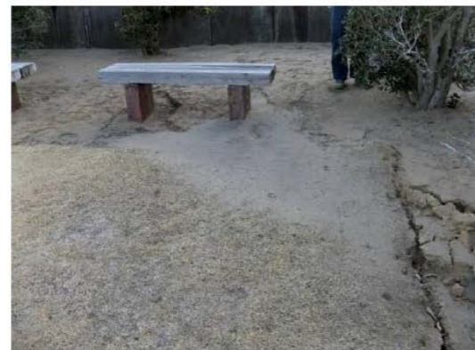
旭市吉崎浜：野外活動施設でみられる亀裂からの噴砂を示す。
