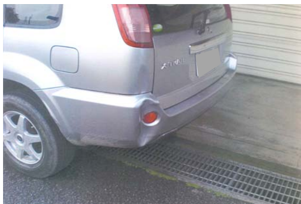
車両損傷状況
