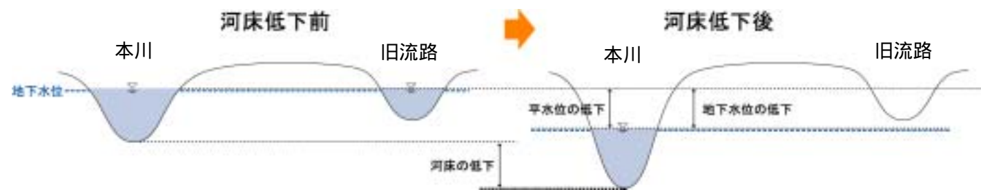
図-7.8 河床の低下と地下水位の低下(模式図)
