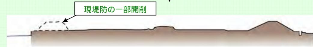
4. ヤード内の一部を掘削し、霞ヶ浦と連続した水面を形成 (模式図)
