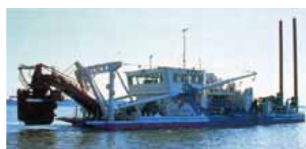
浚渫船 (カスミザウルス)
