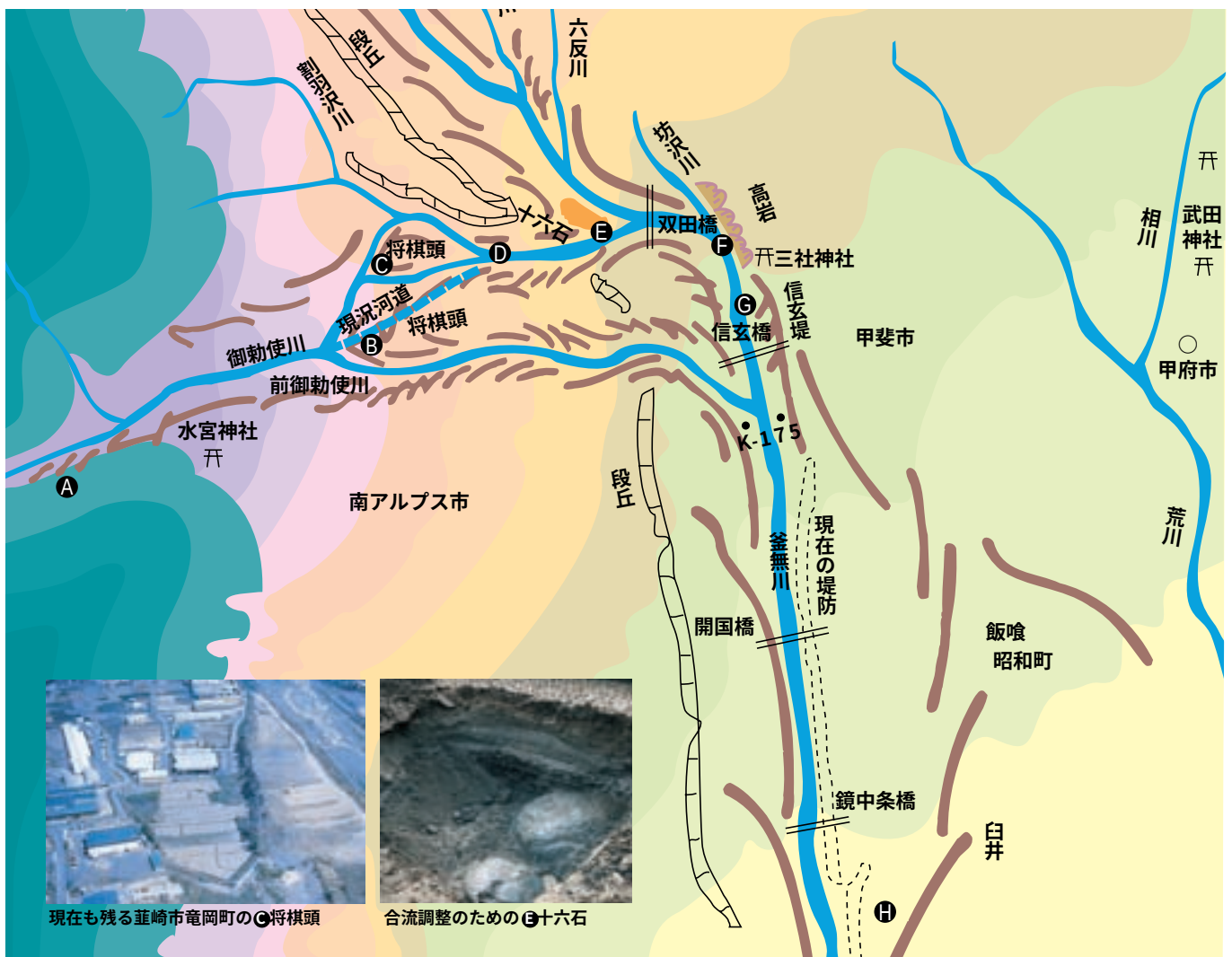
図-5. 釜無川、御勅使川の治水構想図 (明治29年の水害までは2本の御勅使川が流れていた)
