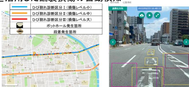
車載カメラからの映像をAIにより画像解析し、舗装損傷状況や区画線のかすれを自動検知
