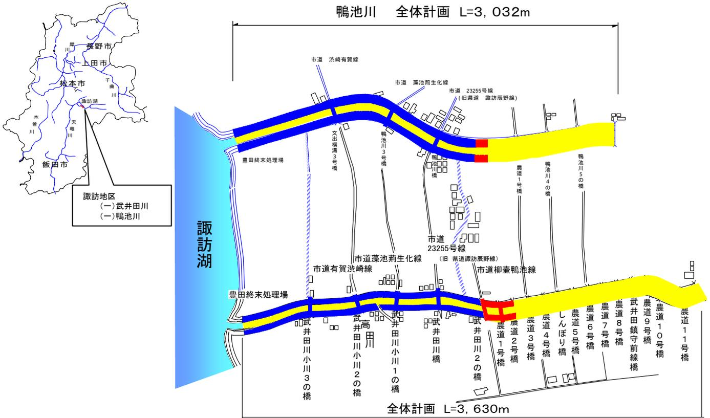
武井田川、鴨池川が流下する諏訪湖東南部は、軟弱な沖積層地帯で地盤沈下が発生し、土砂が河道内に押し出され流下能力が低下しているため、沿川では過去に幾多の浸水被害を被っている。また、近年住宅化が進んでいる箇所でもあり、武井田川・鴨池川期成同盟会からも早期改修を要望されている。
