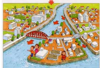
このため神奈川県と横浜市では、協力して大岡川分水路を建設しました。横浜市港南区日野から根岸湾までのトンネル及び開水路(総延長約3.64km)は昭和56年に完成し、台風等による被害を防いでおります。
