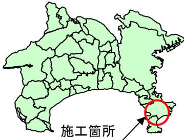
当区域は、神奈川県東部の三浦半島中央部に位置し、二級河川下山川の北側斜面で比較的急峻な山地山麓斜面である。地質的には、葉山層群などが断層運動等により風化作用を受け、潜在的に地すべりを起こしやすい地域となっている。道路、擁壁等に亀裂を生じており、滑落崖や湧水などの地すべり現象が認められる。保全対象には、多数の人家のほか、小学校や主要地方道である県道、防災上重要なNTTの交換センター、災害時要援護者対策としての保全対象である病院が存在する。
